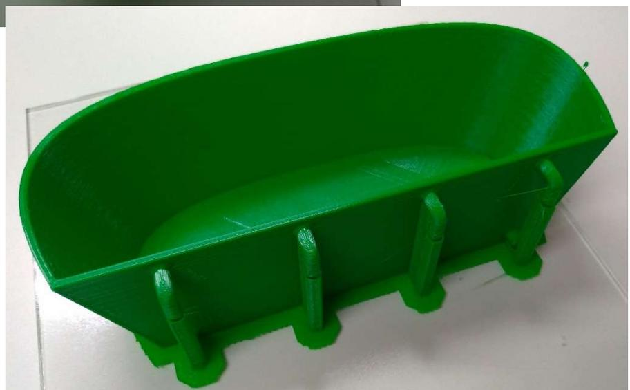
4) *Realizzazione di un prototipo di vaso contenitore, stampato in 3D con filamento di PLA*
