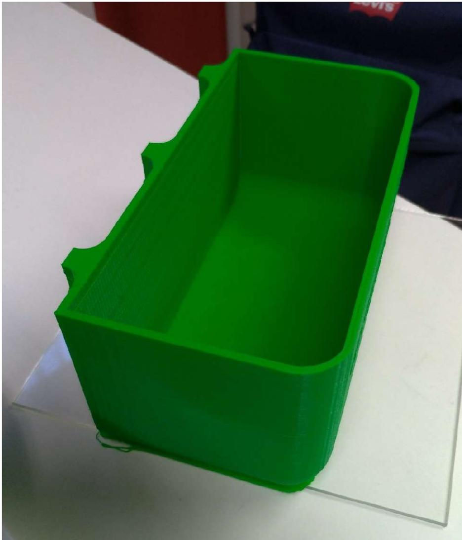
5) Realizzazione di un secondo prototipo di vaso contenitore, stampato con in 3D con filamento di PLA
