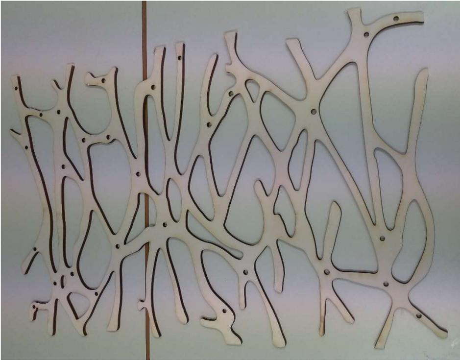
3) *Realizzazione di elemento strutturale in legno eseguita con macchina CNC con taglio laser*
